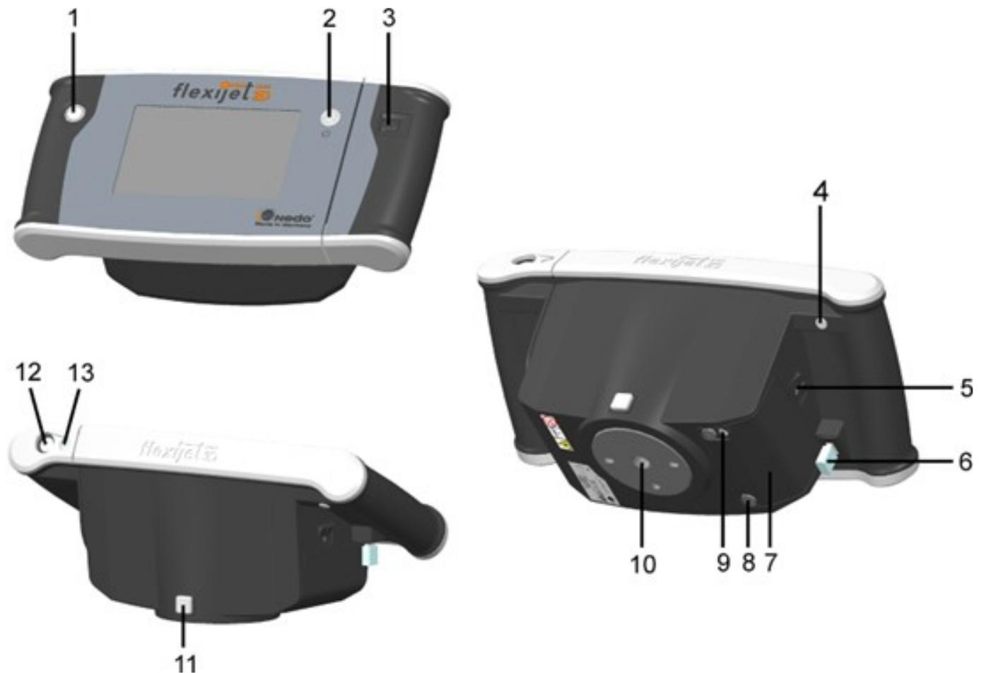
1. „Messauslöser“: Mit dem Messauslöser werden Messungen gestartet. Während eine Messung aktiv ist, leuchtet der LED-Ring um den Messauslöser rot. Während dieser Phase darf das Flexijet 3D nicht bewegt werden.
