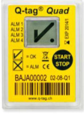
The same yellow Q-tag Quad device, now showing a checkmark on the screen. The 'START' button is now labeled 'STOP'. The text 'BAJA00002 02-08-Q1' and a barcode are visible at the bottom.                                                                                                            | <p>Cuando la medición esté activada, verá un ✓ (indicador OK) y un punto intermitente en la pantalla.</p> |
