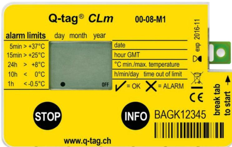
Der Q-tag CLm wird im sogenannten "Sleep Modus" ausgeliefert. Dieser Zustand ist in der Anzeige am konstant leuchtenden Indikator "OFF" und dem blinkenden Punkt (Running Indikator) erkennbar.
