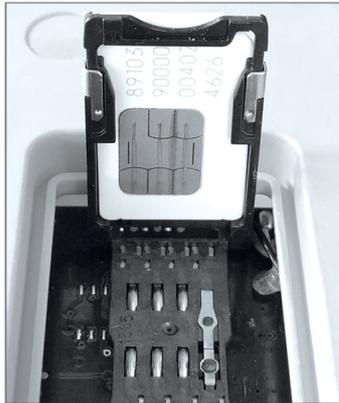
**Plateau d'insertion de la carte SIM avec la carte SIM insérée correctement**
