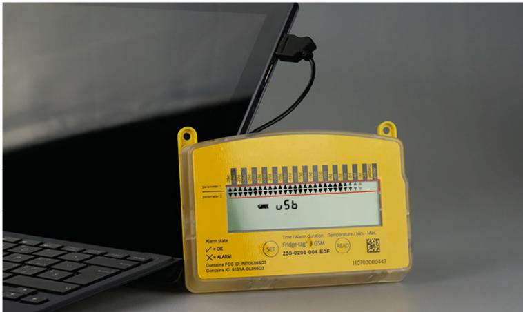
Der Fridge-tag 3 erstellt nun einen PDF- und ASCII-Bericht der letzten 28, 56 Tage (optionale Werkseinstellung). Je nach Konfiguration kann dies bis zu 2 Minuten beanspruchen. Wählen Sie nun die entsprechende Datei aus, die mit dem Fridge-tag 3 erzeugt wurde.
