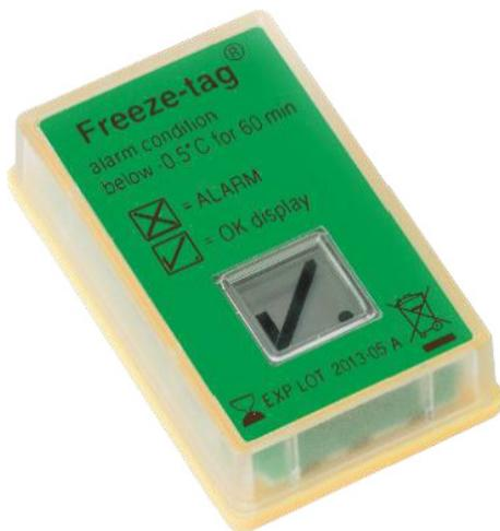
Le Freeze-tag surveille la température de son environnement et vous indique sur l'écran s'il y a eu une exposition inférieure à  $-0,5^{\circ}\text{C}$  /  $+31,1^{\circ}\text{F}$  pendant plus de 60 minutes.
