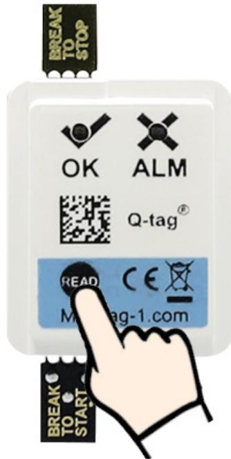
L'appareil est arrêté en appuyant sur la touche READ (préférentiellement avec le bout de l'ongle) pendant au moins 3 secondes.
