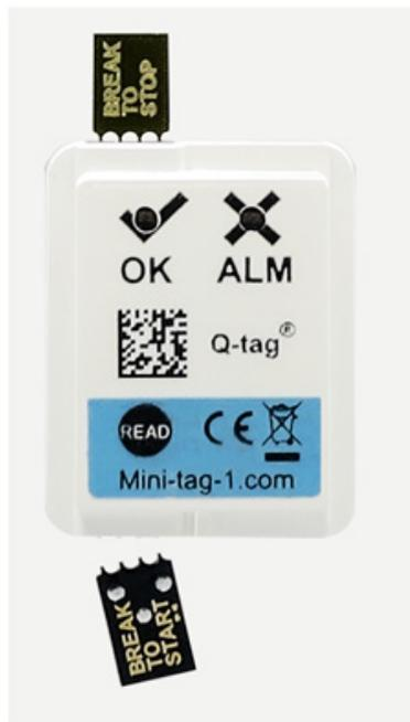
Das Gerät wird gestartet, indem die START-Abbrechlasche (START steht auf der Lasche) vollständig abgebrochen wird.
