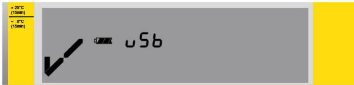
Das Laufwerk des Fridge-tag 2 L wird im Explorer angezeigt. Öffnen Sie die gewünschte Datei, welche vom Gerät generiert worden ist.
