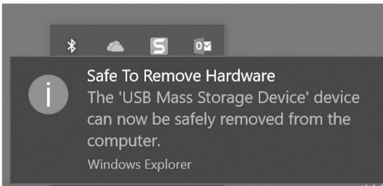
Entfernen Sie das Gerät erst, wenn die nebenstehende Meldung erschienen ist, anderenfalls kann das Gerät beschädigt werden!
